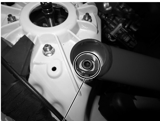
M8キャップボルト締め付けトルク 29N・m (2.96kgf・m)
