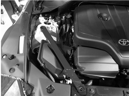
M10×25キャップボルト M10スプリングワッシャー M10平ワッシャー
