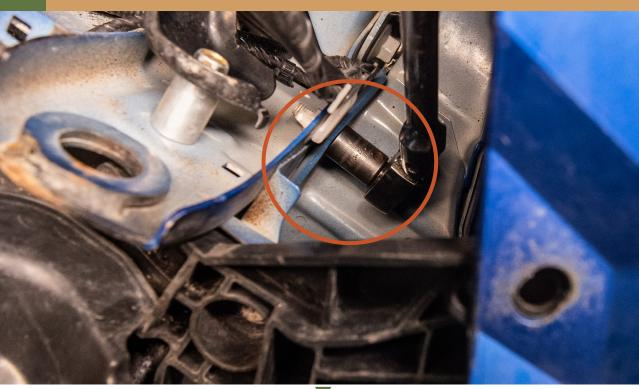
INSTALL BUMPER GUARD SUPPORT RODS.
